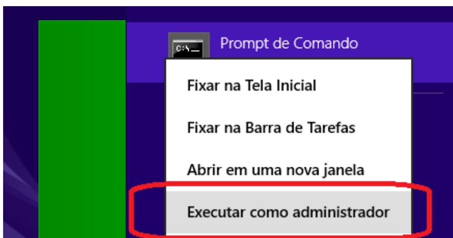
3. Com o Prompt de Comando aberto navegue até o diretório de instalação do FullCopyConvert Data. Como demonstra imagem abaixo e realize o comando de instalação do Serviço “FullCopyConvertService.exe –install”.
